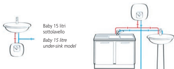
Baby 30 litri sopra lavello (sufficiente per 2 punti di prelievo) Baby 30 litre above sink model (enough for 2 point of use)
